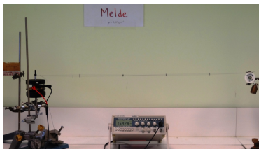
FIGURE – Dispositif expérimental de la corde de Melde.
