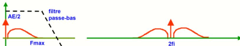
FIGURE – Analyse fréquentielle de la détection synchrone.
