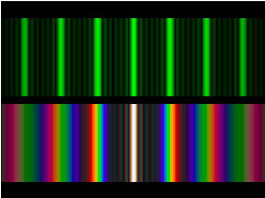
FIGURE 3.3 – Interférence à N ondes dans un reseau et décomposition de la lumière blanche.
