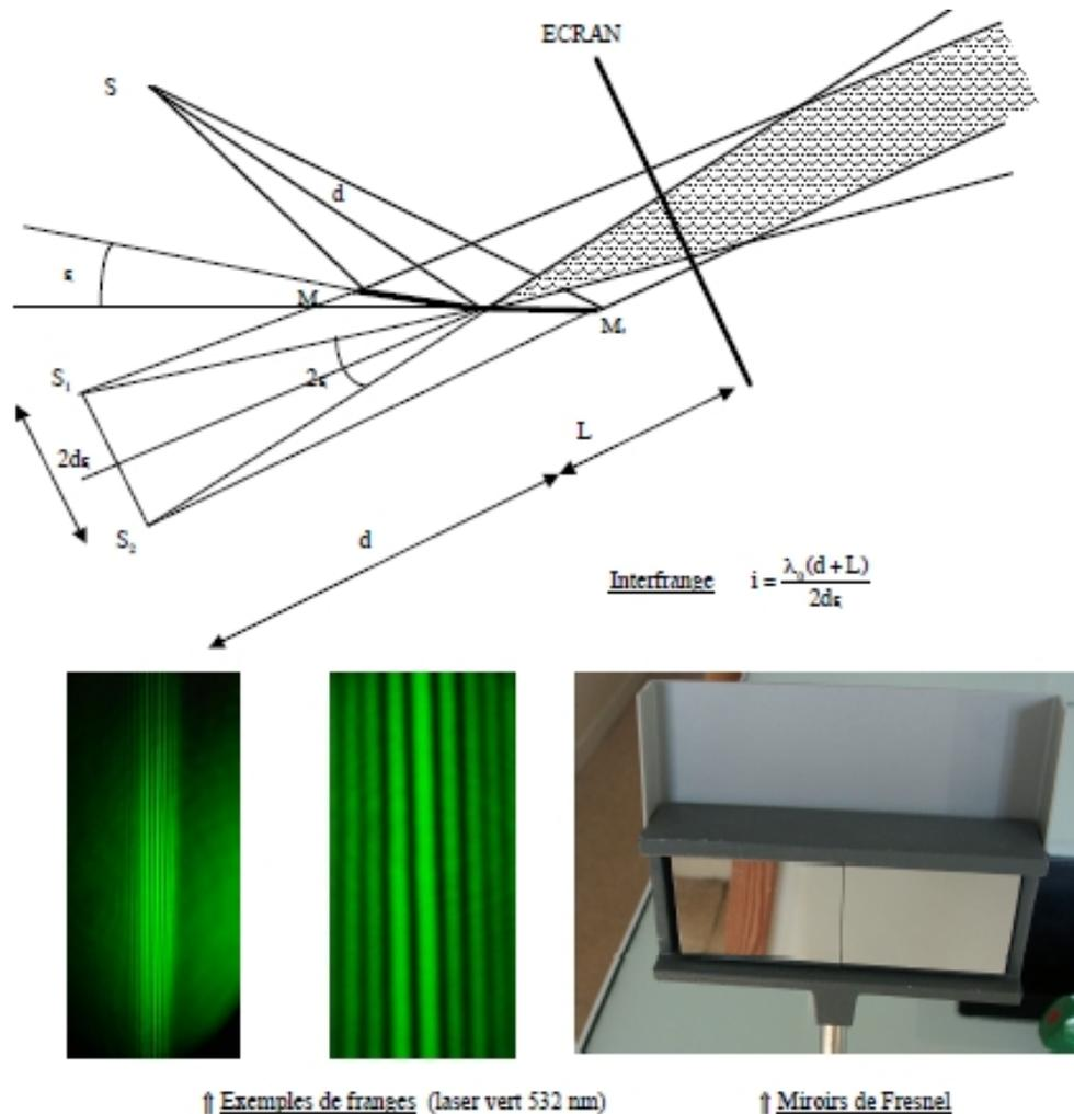
FIGURE 2.1 – Le dispositif interférométrique des miroirs de Fresnel.
