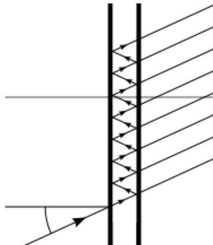
FIGURE 2.5 – La lame du filtre interférentiel (seuls les rayons transmis sont représentés).
