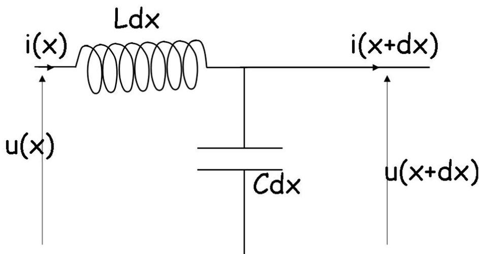
FIGURE 1.2 – Modèle d'une tranche  $dx$  de câble coaxial idéal .
