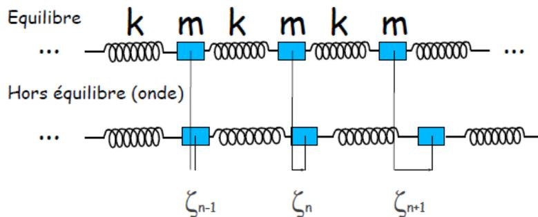
FIGURE 1.1 – Chaîne infinie d'atomes, modèle de la propagation du son dans les solides.
