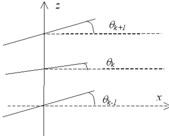
FIGURE 1.2 – Echelle de perroquet : la barre  $n$  se meut dans le plan  $O_nxy$  perpendiculaire à  $z$ .
