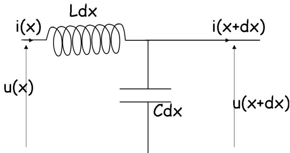
FIGURE 1.3 – Modèle d'une tranche  $dx$  de câble coaxial idéal .
