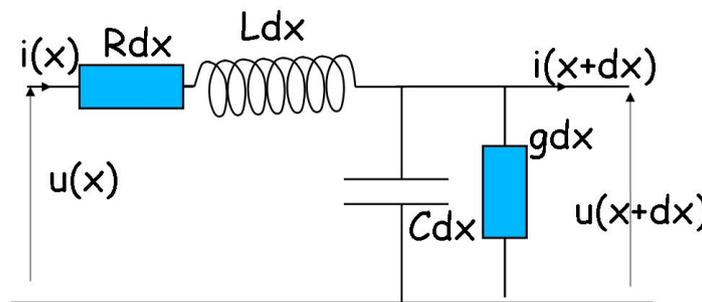
FIGURE 2.1 – Modèle d'une tranche  $dx$  d'un câble coaxial réel.
